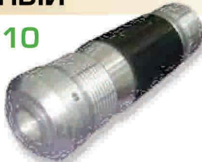
Пакер разбуриваемый сменный ПРС-210 в комплекте с гидроловкой ГП-195 применяется в качестве уплотнителя для разобщения затрубного пространства от зон поглощения при изоляции этих зон в скважинах диаметром 219,1 мм и 220,7 мм, а также для отсечения нижней части ствола скважины для создания искусственного забоя.
