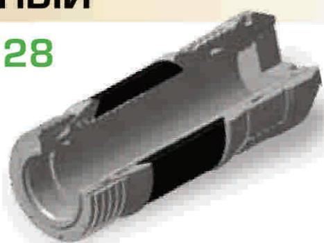
Пакер разбуриваемый сменный ПРС-128 в комплекте с гидроголовкой ГП-128М.З-86 применяется в качестве уплотнителя для разобщения затрубного пространства от зон поглощения при изоляции этих зон в скважинах диаметром 139,7-142,9 мм, а также для отсечения нижней части ствола скважины для создания искусственного забоя.
