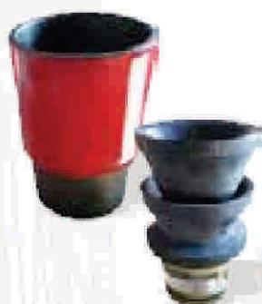
УЦК предназначено для проведения операции цементирования обсадной колонны в одну ступень. Состоит из пробки и стоп-кольца, в котором внутренняя геометрия имеет ответную часть под наконечник пробки.
