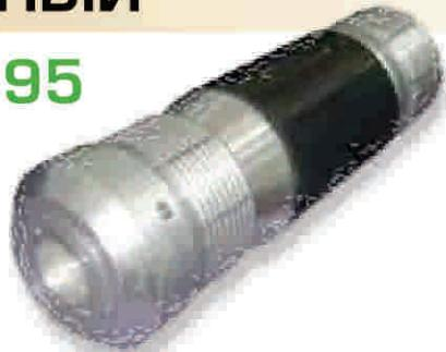
Пакер разбуриваемый сменный ПРС-195 в комплекте с гидроловкой ГП-195 применяется в качестве уплотнителя для разобщения затрубного пространства от зон поглощения при изоляции этих зон в скважинах диаметром 215,9 мм, а также для отсечения нижней части ствола скважины для создания искусственного забоя.
