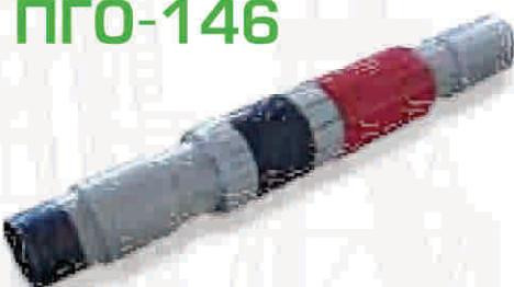
Пакер-отсекатель ПГО-146 предназначен для повышения качества разобщения близкорасположенных пластов при цементировании эксплуатационных колонн Ø146 мм с формированием высокопрочной, герметичной резино-цементной перемычки.
