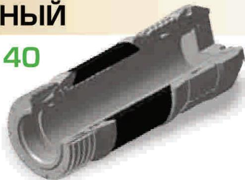
Пакер разбуриваемый сменный ПРС-140 в комплекте с гидроголовкой ГП-128М.З-86 применяется в качестве уплотнителя для разобщения затрубного пространства от зон поглощения при изоляции этих зон в скважинах диаметром 152,4-155,6 мм, а также для отсечения нижней части ствола скважины для создания искусственного забоя.
