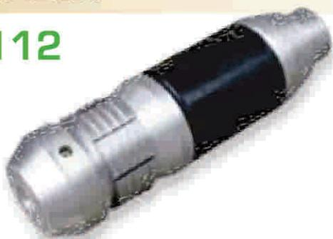
Пакер разбуриваемый сменный ПРС-112 в комплекте с гидроГоловкой ГП-112 применяется в качестве уплотнителя для разобщения затрубного пространства от зон поглощения при изоляции этих зон в скважинах диаметром 126 мм, а также для отсечения нижней части ствола скважины для создания искусственного забоя.
