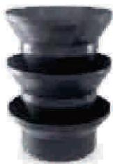
Применяются при проведении цементировочных (тампонажных) работ в скважине для разобщения тампонажного раствора и продавочной жидкости, прокачиваемых в обсадной колонне, очистки внутренней поверхности обсадных труб от остатков цементного раствора, а также получения сигнала об окончании процесса цементирования («стоп»).
